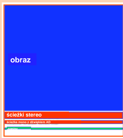
Ilustracja 27: Dostarczanie audiodeskrypcji (miks w odbiorniku) w sygnale telewizji cyfrowej
